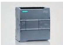
CPU 1211C DI 6x24 V DC, DQ 4x24 V DC or 4xRLY, AI 2x10 Bit 0–10 V DC DC/DC/DC 6ES7 211-1AD30-0XB0 AC/DC/RLY 6ES7 211-1BD30-0XB0 DC/DC/RLY 6ES7 211-1HD30-0XB0
